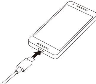
② USB-Aポートまたは、USB Type-Cポートに充電対象機器の充電に対応したケーブルを接続します。
