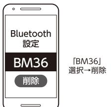
①本製品の初期化操作前にスマートフォン側、接続機器リスト内の型式名「BM36」は、スマートフォンを操作し必ず削除してください。
