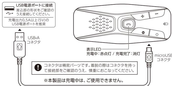
①本製品の充電用ポートに付属の充電用USBケーブルを差し込み、USB電源ポートに接続してください。
