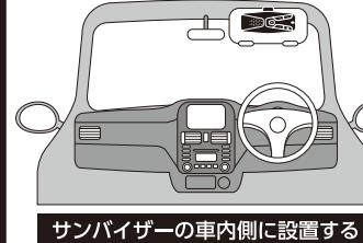
サンバイザーの車内側に設置する
