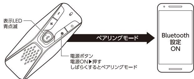
スピーカー電源ON操作後、下記ボイスアナウンスが流れます。
