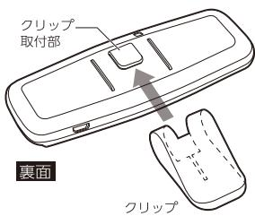
②クリップをクルマのサンバイザーパートにはさみ込み装着してください。
