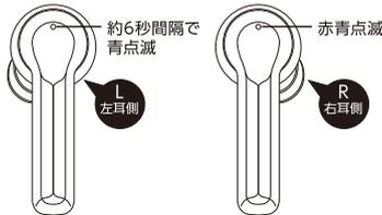
※ペアリング済み機器がBluetooth設定ONの状態で近くにあると、本製品がその機器との接続を優先するためペアリングモードにならない場合があります。新たな機器とペアリングをおこなう際は既にペアリング済みの機器のBluetooth設定をOFFにしてください。※ペアリングモード (LED赤青交互点滅) が約5分間継続すると、本製品の電源は自動的にOFFになります。
