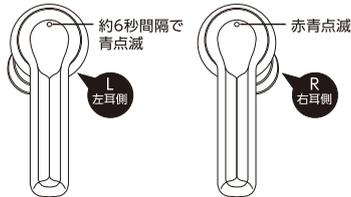
※ペアリング済み機器がBluetooth設定ONの状態で見ると、本製品がその機器との接続を優先するためペアリングモードにならない場合があります。新たな機器とペアリングをおこなう際は既にペアリング済みの機器のBluetooth設定をOFFにしてください。
