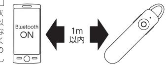
①ヘッドセットの電源スイッチを上にスライドして電源をONにしてください。
