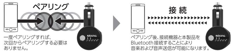
**① 本製品をカープラグに接続して電源ONになった時点でペアリングモードになります。** LINK LEDが連続で青と赤が交互に点滅します。接続機器を1m以内に近づけ、途中で障害になる物が無いことをご確認ください。
